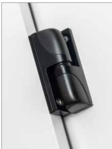
Steigendes Federband mit Schließhilfe- und Feststellfunktion. Das Band sorgt für ein selbstständiges Schließen der Tür nach dem Öffnen.
