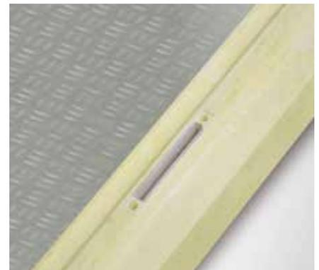
Bei der Montage unserer Zellen werden die einzelnen Elemente mittels Nut-Federverbindung und eingeschäumten, korrosionsgeschützten Exzenter-Spannverschlüssen dicht miteinander verbunden. Die Verriegelung erfolgt im Normalfall von der Zelleninnenseite. Dieses System (Abbildungen links) ist einfach zu handhaben, stabil, zuverlässig und bietet Ihnen zudem größtmögliche Flexibilität für Entwicklungen und Veränderungen. So können die Zellen bequem räumlich variiert werden.
