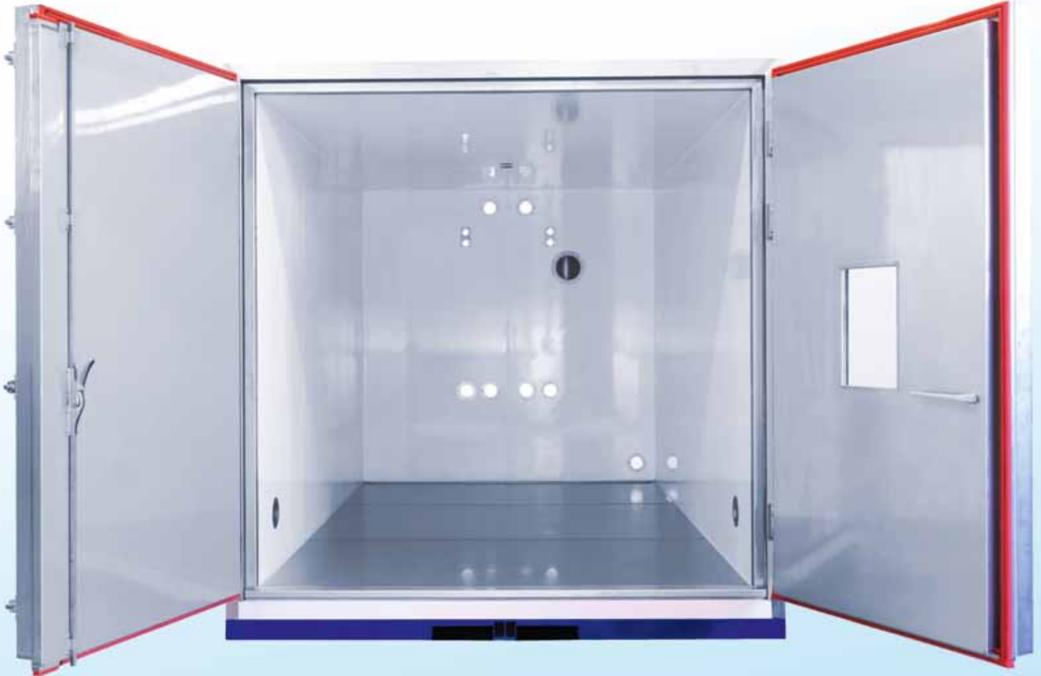
Klimazelle mit verschweißtem Zellenboden, Zellenwände und Decke mit Versiegelungsfuge je nach Temperaturbereich ca. 6 mm breit, Rückwand vorgerichtet für den Einbau eines Wärmetauschers und einer Luftleitwand.
