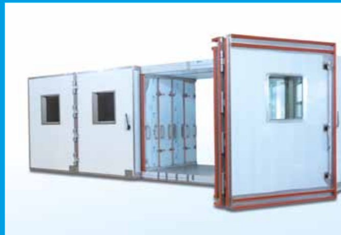
Die Front der Klimazelle – hier bei der Probemontage – kann durch die aufklappbaren Türen komplett freigelegt werden
